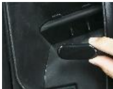
Fig. 4 – Ubicación del controlador (Guantera derecha)
